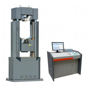
试验机智能化的三种基本配置:主机、微电脑、还有打印机,如果微电脑功能强可以直接打印。另外也可配备普通电脑。有了电脑,就可以进行复杂的数据分析,如数据编辑,局部放大,可调整报告形式,进行成组式样的统计分析。主要根据软包装薄膜的需要测试的性能和要求,行程在600\[\(\)800\(\)mm就可以。材料伸长率超
